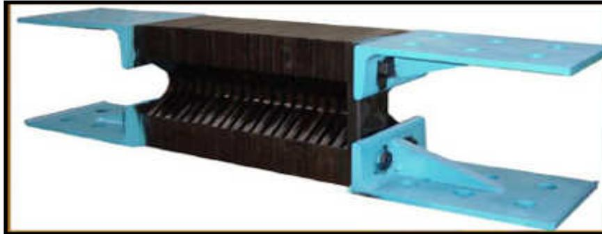
以鋼板為材料，為一種易降服且高效能的結構防震裝置，主要藉由鋼板降服後的非彈性變形來吸收地震進入結構的能量
